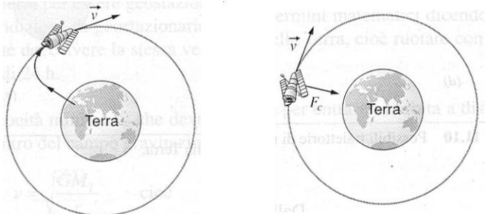
Se il satellite viene portato a una certa altezza  $h$  rispetto alla superficie terrestre e gli viene impressa una velocità  $v$  in direzione perpendicolare alla forza di gravità, il moto segue le leggi che abbiamo visto per le masse che ruotano intorno al Sole,
