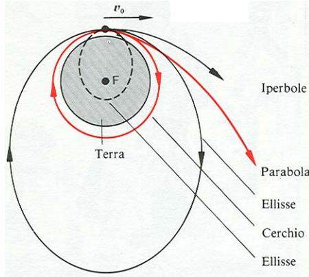
Traiettorie descritte sotto l'azione della gravità terrestre. Se la velocità di lancio orizzontale alla superficie della Terra è più piccola della velocità corrispondente all'orbita circolare, il corpo ricade sulla Terra.
