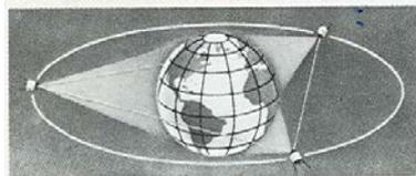
Tre satelliti geostazionari che ruotano attorno alla Terra. Se ogni satellite impiega un giorno per compiere una rotazione completa, e le loro orbite giacciono sul piano equatoriale terrestre, i satelliti visti dalla Terra sembrano fermi. Essi sono quindi estremamente utili per la trasmissione radio e televisiva.
