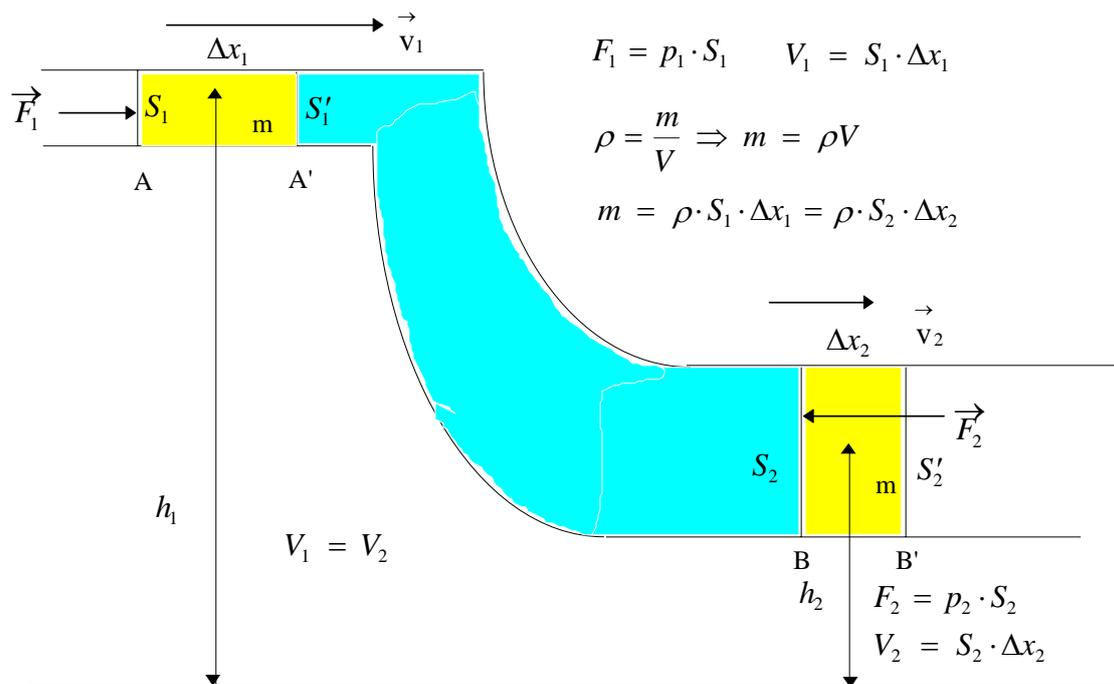
Una porzione di liquido ideale ( prima porzione in giallo , seconda porzione in azzurro ) si muove in un tubo di flusso da sinistra verso destra passando dalla configurazione AB alla configurazione A' B' .
