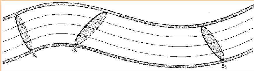
Se nel tempo  $t$  passa un volume  $V$  di fluido attraverso una sezione normale  $S$ , allora si definisce **portata attraverso la sezione normale S**
