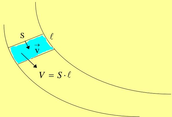
La **portata di un tubo di flusso** rappresenta il rapporto  $Q$  tra il volume di liquido che passa attraverso una sezione del tubo di flusso nel tempo  $t$  ed il tempo  $t$  stesso.
