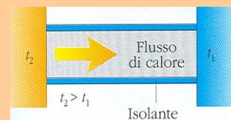
Conduzione di calore attraverso una sbarra isolata , con estremità mantenute a temperature  $t_1$  e  $t_2$  costanti .
