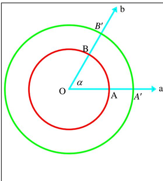
La misura ( $\alpha^R$ ) in radianti di un angolo o di un arco è un numero puro in quanto rapporto di due grandezze (**lunghezze**) omogenee. La misura di un angolo (arco) in **radianti** è detta **misura ciclotometrica** dell'angolo (arco). La **misura ciclotometrica** di un arco coincide con la **misura ciclotometrica** del corrispondente angolo al centro. Dalla [1] ricaviamo:  $\ell = \alpha^R \cdot r$  [2]
