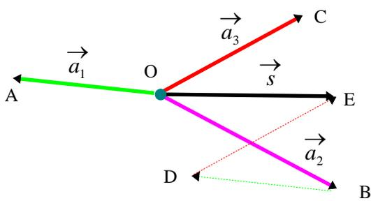
Si possono sommare i vettori a due a due fino ad ottenere il vettore somma  $\vec{s}$ , oppure da B si traccia il vettore equipollente ad  $\vec{a}_1$ , da D il vettore equipollente ad  $\vec{a}_3$ .  $\mathbf{E - O = \vec{s}}$  è il **vettore somma**.
