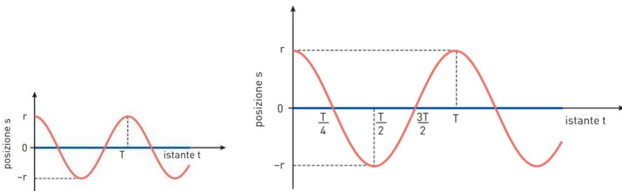
$$v = -\omega r \sin \omega t = -\frac{2\pi}{T} r \sin \frac{2\pi}{T} t = \text{velocità scalare istantanea}$$
