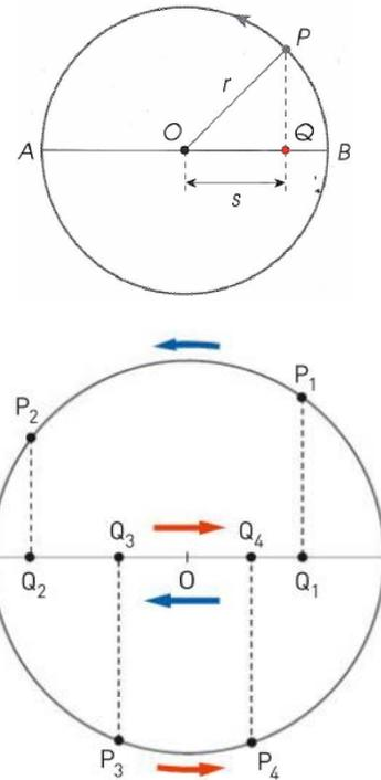
In ogni istante la velocità vettoriale del punto Q è la proiezione ortogonale della velocità  $\vec{v}_o$  del punto P lungo il diametro AB.
