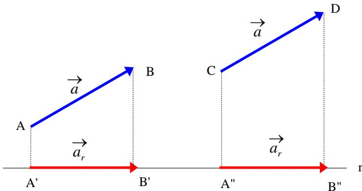
$\vec{a}_r$  è il **componente** del vettore libero  $\vec{a}$  secondo la retta non orientata  $r$
