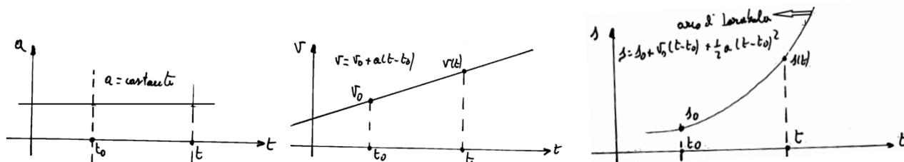
**Diagrammi** dell'**accelerazione**, della **velocità**, della **posizione** per un moto uniformemente accelerato su una traiettoria prestabilita quando il mobile passa dalla posizione  $P_0$ , individuato dall'ascissa curvilinea  $s_0$ , alla posizione **P** individuata dall'ascissa curvilinea **s**.
