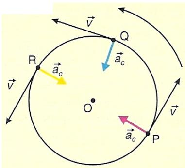
**Vettore accelerazione nel moto circolare uniforme:**
