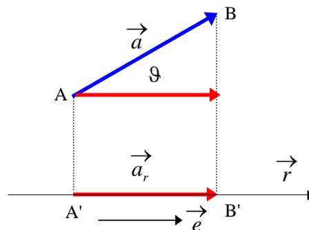
Siano  $r$  ed  $s$  due rette non orientate complanari. Sia  $O$  il loro punto d'intersezione. Sia  $\vec{a}$  un vettore non nullo del piano  $rs$ , di tipo qualsivoglia, cioè libero o applicato in un punto o lungo la sua retta d'azione.  $\overrightarrow{AB}$  sia un segmento orientato rappresentativo del vettore  $\vec{a}$ . Dai punti  $A$  e  $B$  tracciamo le rette parallele ad  $r$  ed  $s$ . Otteniamo i punti  $A_1, A_2, B_1, B_2$  e la seguente relazione vettoriale:
