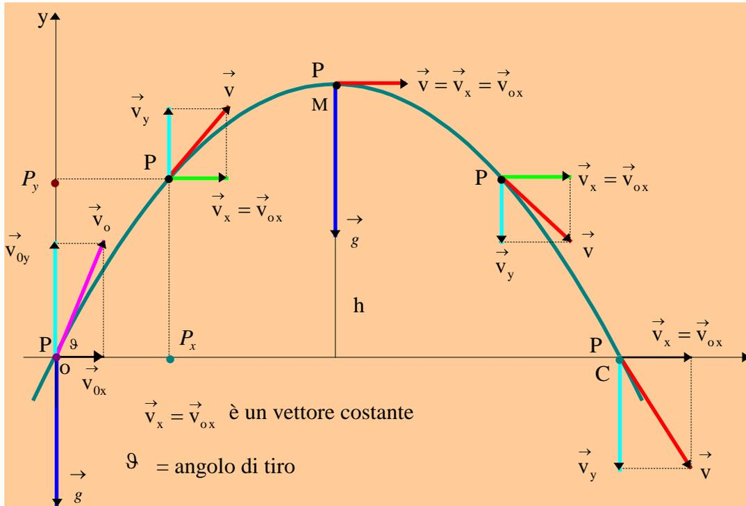
$$\begin{cases} a_x = 0 \\ a_y = -g \end{cases} \quad \begin{cases} v_x = v_{0x} \\ v_y = v_{0y} - gt \end{cases} \quad \begin{cases} x = v_{0x} \cdot t \\ y = v_{0y} \cdot t - \frac{1}{2}gt^2 \end{cases}$$
