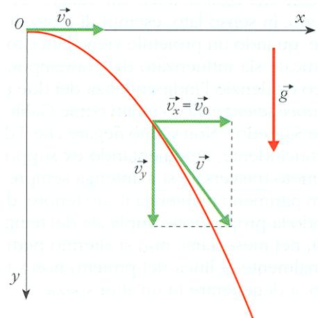
Il moto del proiettile, per il principio di indipendenza delle azioni simultanee, può essere dedotto dalla composizione dei moti di due punti ( $P_x$  e  $P_y$ ) che muovono lungo due rette ortogonali.  $P_x$  si muove di moto rettilineo uniforme  $P_y$  si muove di moto rettilineo uniformemente vario.
