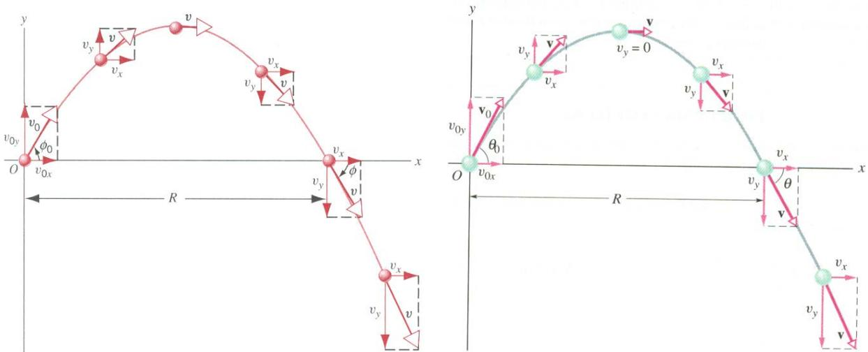
Traiettoria di un proiettile lanciato con velocità  $\vec{v}_0$ . E' indicata la velocità iniziale  $\vec{v}_0$  con le sue componenti. E' indicata la velocità  $\vec{v}$  con le proprie componenti in cinque istanti diversi. Notare che risulta sempre  $v_x = v_{0x}$ . La gittata R (G) è la distanza orizzontale descritta dal proiettile quando ripassa alla quota del lancio.
