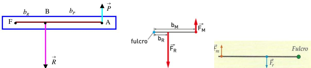
In questo tipo di leva il punto di applicazione della resistenza è tra il fulcro ed il punto di applicazione della potenza. La leva di secondo genere è sempre **vantaggiosa** in quanto è sempre:
