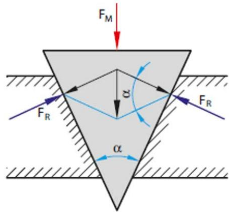
Esempi di cuneo sono i coltelli, la scure, i rasoi ed altro. La teoria del cuneo può riportarsi a quella del piano inclinato. Nel caso particolare che la base abbia la forma di un triangolo rettangolo, esso si può considerare un piano inclinato. Sia  $ABC$  la sezione del cuneo parallela alla base e contenente il baricentro del cuneo stesso.
