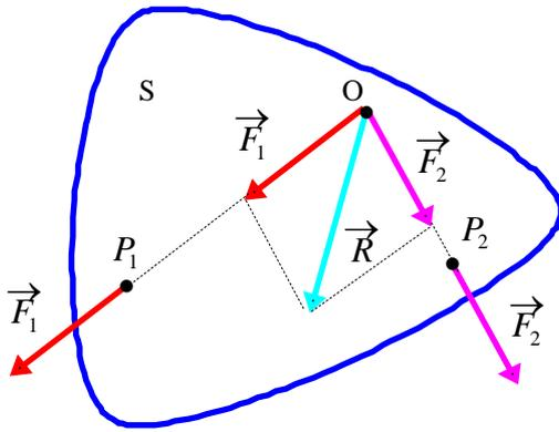
Due o più forze si dicono **concorrenti** quando i loro sostegni passano per uno stesso punto. Un sistema di due o più forze applicate ad un corpo rigido  $S$  e concorrenti in un punto  $O$  è equivalente al sistema delle stesse forze applicate al punto  $O$ , potendosi trasportare ciascuna forza lungo la propria retta d'azione.
