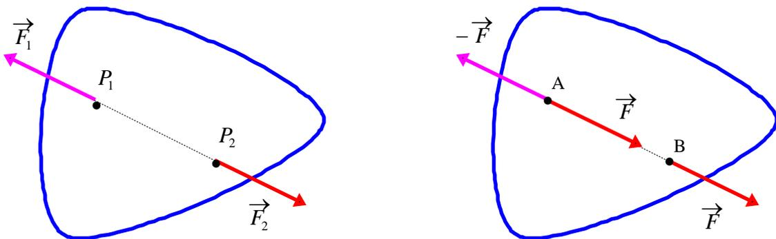
Infatti se B è un punto del sostegno di  $\vec{F}$  distinto da A, per il postulato precedente posso immaginare di applicare in B le forze direttamente opposte  $(B, -\vec{F})$  e  $(B, \vec{F})$ , ottenendo un sistema equivalente di forze:
