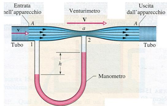
È costituito da tre segmenti di tubo **A**, **B**, **C** raccordati e disposti con l'asse orizzontale. **A** e **C** hanno sezione  $S_A = S_C = S_1$ ; il tratto **B** ha sezione  $S_B = S_2 < S_1$ .
