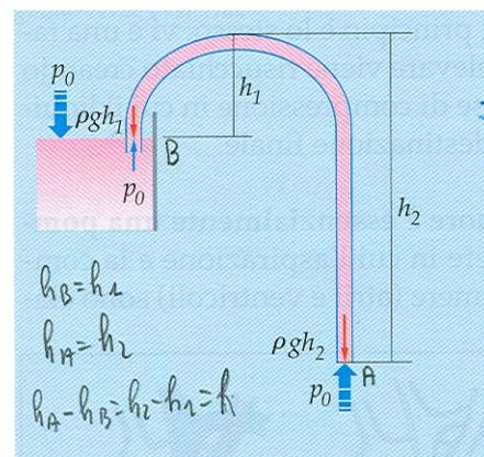
Vogliamo dimostrare che la velocità di efflusso dalla superficie A del sifone si ottiene applicando la seguente formula:  $v = \sqrt{2gh}$  con  $h = h_2 - h_1 =$  dislivello rispetto alla superficie libera.
