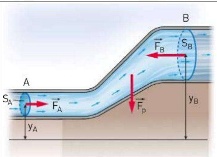
L'**equazione di Bernoulli** è l'equazione più importante della **dinamica dei fluidi**. Essa descrive il moto attraverso un **condotto** di un **fluido ideale**, cioè di un fluido incompressibile e privo di attrito interno, come mostrano le seguenti figure. L'applicazione del principio di conservazione dell'energia al moto dei liquidi perfetti porta alla scoperta di una legge che costituisce il fondamento dell'idrodinamica: il **teorema di Bernoulli**.
