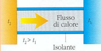
Conduzione di calore attraverso una sbarra isolata, con estremità mantenute a temperature  $t_1$  e  $t_2$  costanti .
