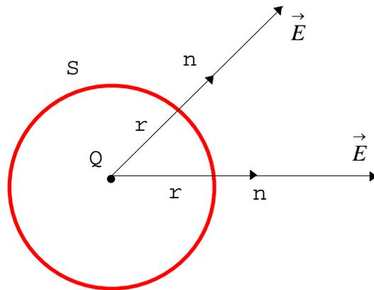
Il risultato ottenuto è generalizzabile ad una superficie chiusa qualsiasi che contenga al suo interno la carica totale  $Q_{tot}$ , somma algebrica di tutte le cariche presenti all'interno della superficie gaussiana.
