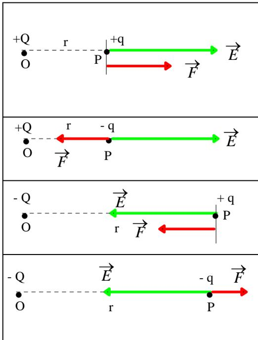
Il vettore campo elettrico  $\vec{E}$  per una **carica-sorgente** positiva (  $+Q$  ) è diretto nel verso che si allontana dalla sorgente , qualunque sia la carica di prova  $q$  ( positiva o negativa )
