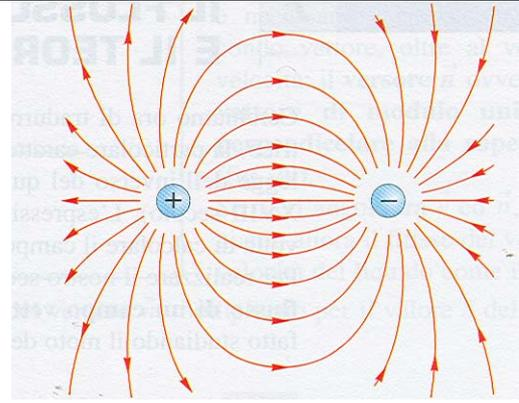
**Linee di campo di un dipolo, sistema costituito da due cariche elettriche di segno opposto ma uguale valore**
