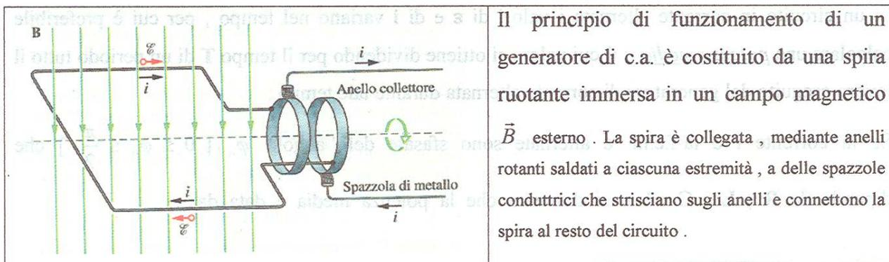
Il principio di funzionamento di un generatore di c.a. è costituito da una spira ruotante immersa in un campo magnetico  $\vec{B}$  esterno. La spira è collegata, mediante anelli rotanti saldati a ciascuna estremità, a delle spazzole conduttrici che strisciano sugli anelli e connettono la spira al resto del circuito.
