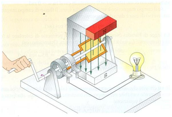
**Alternatore** è un qualsiasi dispositivo capace di creare una **corrente alternata**, cioè **una corrente che varia nel tempo sinusoidalmente**. Il più semplice alternatore risulta costituito da:
