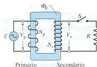
**Trasformatore.** Alimentando il circuito primario con una **f.e.m. alternata**  $\varepsilon_1(t)$ , nel secondario si genera, per induzione elettromagnetica, una **f.e.m. alternata**  $\varepsilon_2(t)$  avente la stessa frequenza
