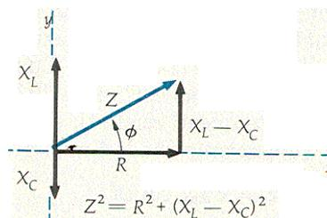
Il circuito RLC e le tensioni ai capi della resistenza  $R$ , dell'induttanza  $Z$  e della capacità  $C$
