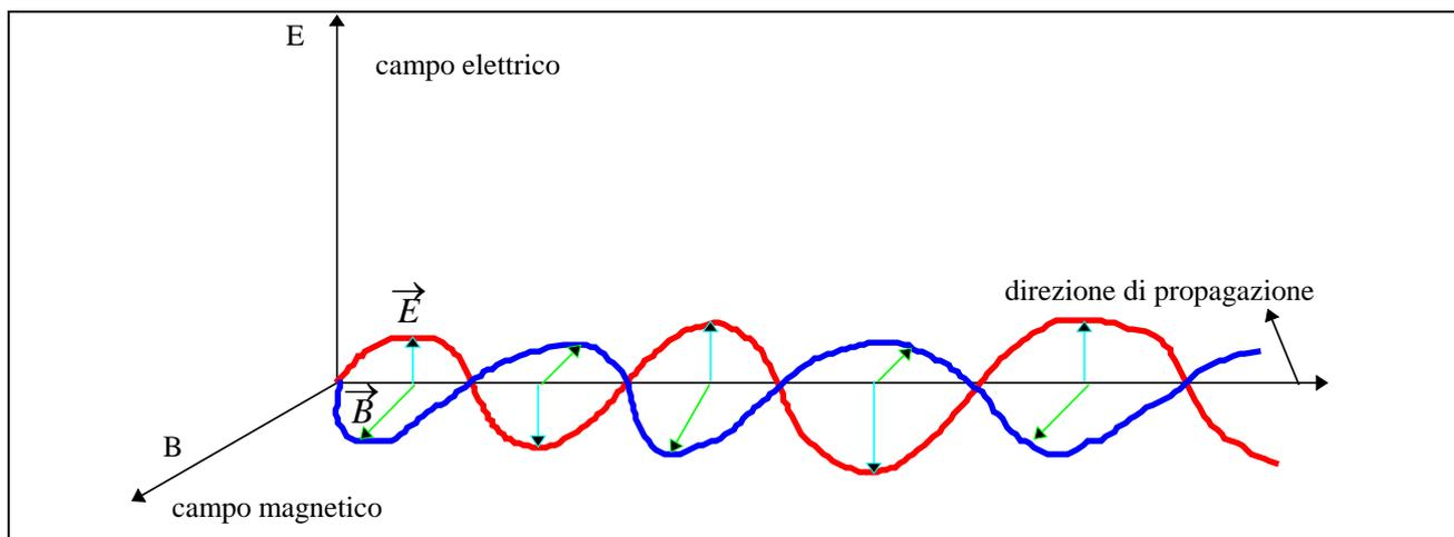
Rappresentazione di un'onda elettromagnetica sinusoidale polarizzata rettilineamente. Le vibrazioni del campo elettrico e del campo magnetico avvengono in piani ortogonali fissi. Si noti che i vettori  $\vec{E}$  e  $\vec{B}$  sono costantemente in fase, oltre che in un dato istante, anche nei vari punti dello spazio, anche in ogni punto nei successivi istanti.
