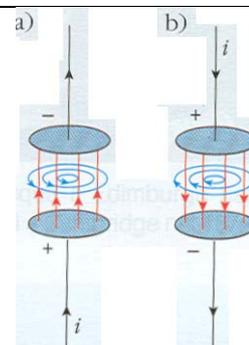
Ad un campo elettrico  $\vec{E}$  uniforme **(a)** non si accompagna la presenza di un campo magnetico  $\vec{B}$ . Se invece il campo elettrico  $\vec{E} = \vec{E}(t)$  varia nel tempo **(b)** si genera nello spazio compreso tra le due armature un campo magnetico  $\vec{B}$ .
