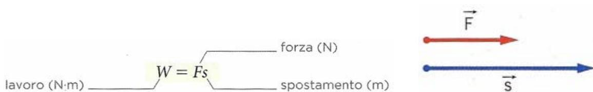
Nel SI l'unità di misura del lavoro è il **joule** definito come il lavoro compiuto da una forza di un newton quando sposta il suo punto di applicazione di un metro nella direzione e nel verso della forza.  $1J = 1N \cdot 1m$
