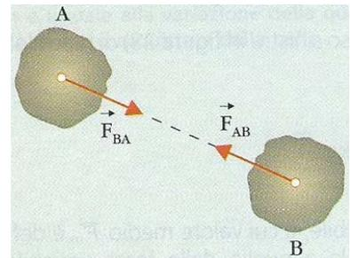
Applico ai corpi  $A$  e  $B$  il terzo principio della dinamica; ottengo:  $\vec{F}_{BA} = -\vec{F}_{AB}$
