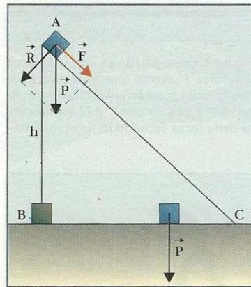
Figura 6. Se si lascia scivolare il corpo della figura precedente lungo un piano inclinato di altezza  $h$  da A a C e poi lo si spinge da C a B, il lavoro compiuto dal peso è ancora  $mgh$ , come nella caduta libera.
