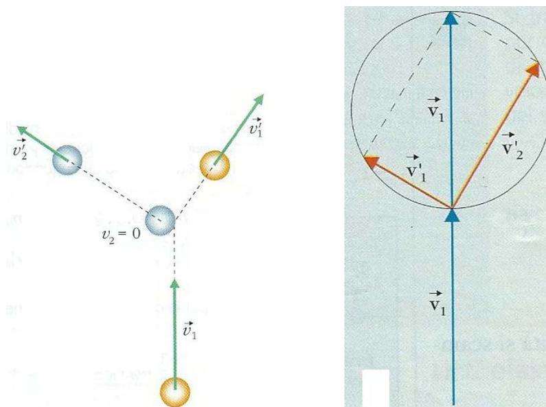
Per la conservazione della quantità di moto possiamo scrivere:  $m \vec{v}_1 = m \vec{v}'_1 + m \vec{v}'_2 \quad \vec{v}_1 = \vec{v}'_1 + \vec{v}'_2$
