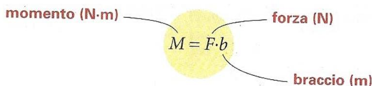
Una forza può fare ruotare un corpo rigido in senso orario o in senso antiorario. Per convenzione assumiamo che il momento di una forza abbia valore **positivo** (**negativo**) quando la forza genera una **rotazione antioraria** (oraria).
