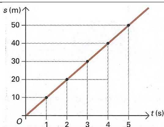
Diagramma orario di un moto rettilineo uniforme con  $s_0 = 0$
