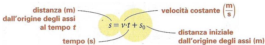
Il **diagramma orario** del moto rettilineo uniforme è una retta, mentre il **diagramma della velocità** è una retta parallela all'asse dei tempi.
