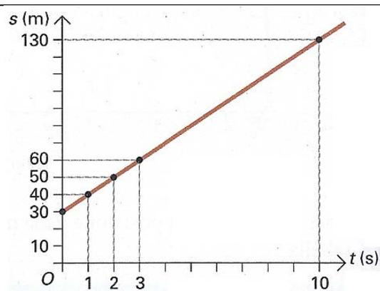
Diagramma orario di un moto rettilineo uniforme con  $s_0 \neq 0$
