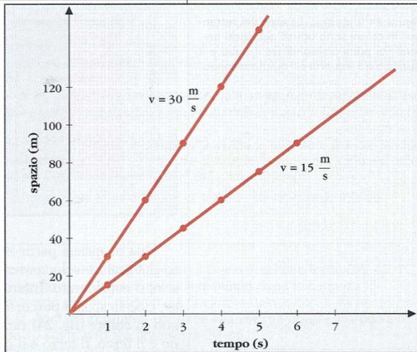
Diagrammi di due automobili che viaggiano alle velocità  $15 \frac{m}{s}$  e  $30 \frac{m}{s}$
