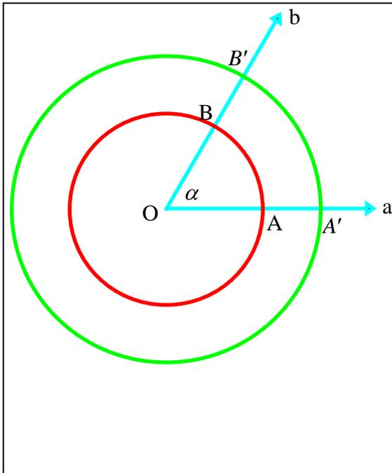
La misura ( $\alpha^R$ ) in radianti di un angolo o di un arco è un numero puro in quanto rapporto di due grandezze (**lunghezze**) omogenee.
