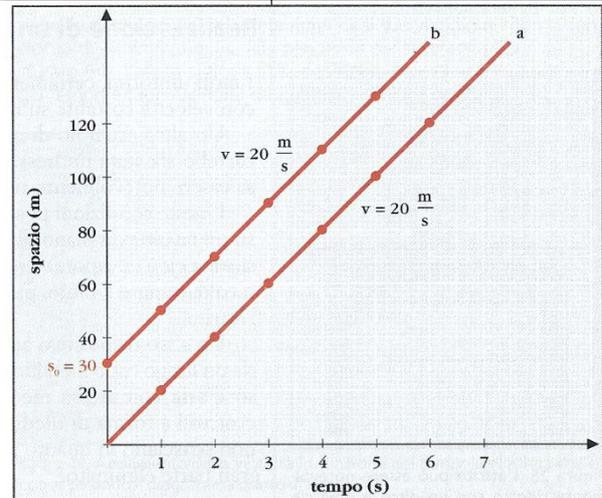
Diagrammi di due automobili che viaggiano entrambe alla velocità di  $20 \frac{m}{s}$  ma: (a)  $s_0 = 0$  (b)  $s_0 = 30m$
