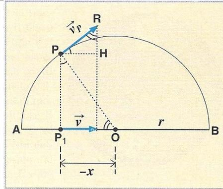
Il moto armonico è un moto rettilineo vario con la velocità scalare che **aumenta** (**diminuisce**) quando il punto materiale si **avvicina** (si **allontana**) al (dal) centro di oscillazione  $O$ . La velocità è **massima** al centro è **nulla** agli estremi dove si ha l'inversione del moto.
