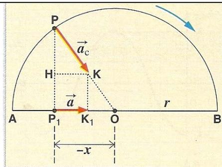
L'accelerazione di un moto armonico si calcola applicando le seguente formula:  $a = -\omega^2 x$
