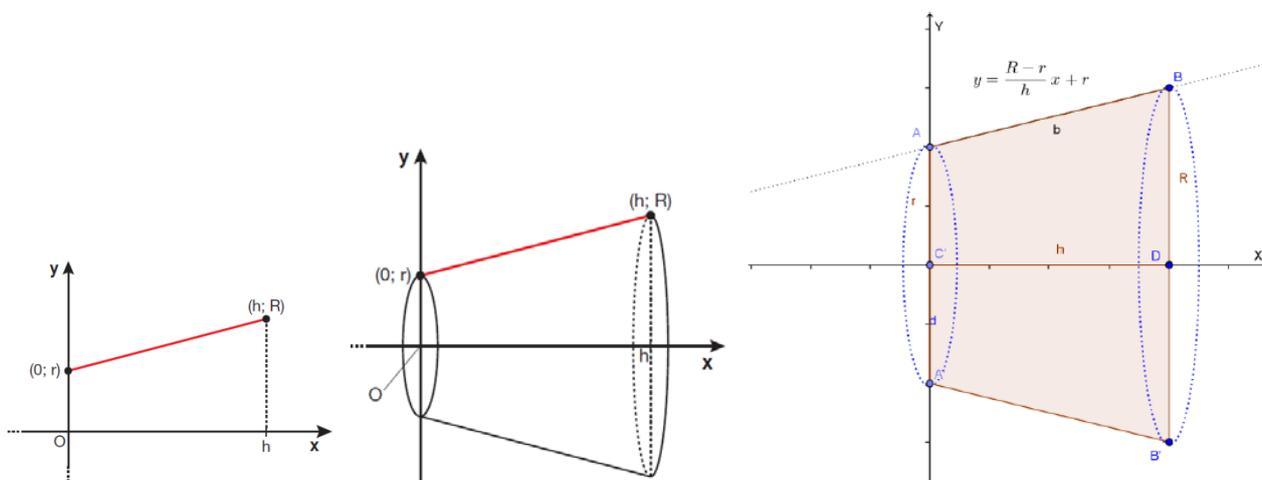
Il volume del solido ottenuto dalla rotazione del segmento di estremi  $A(0;r)$  e  $B(h;R)$  attorno all'asse delle ascisse è il volume del tronco di cono richiesto.
